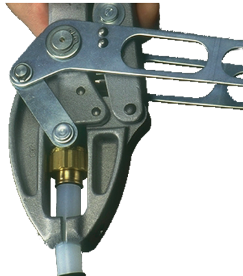
11. Kapp innerrørene og monter kplinger.
