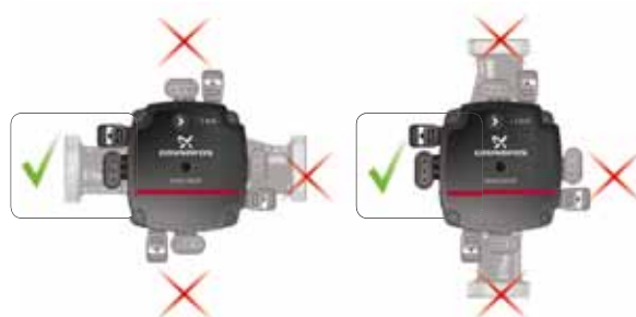
Fig. 6 Kontrolbokspositioner, ALPHA SOLAR
