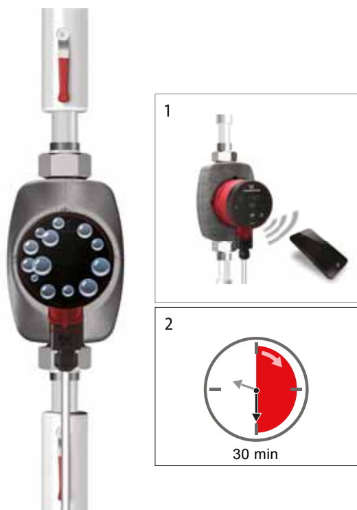
Fig. 7 Utlufting av pumpen
