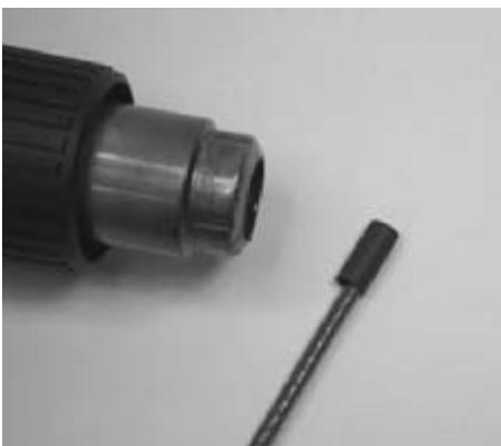
2. Krympeflex 6/2, L = 20 mm trækkes ind over enden af kablet til kanten af den afskårne yderkappe, så 5 mm stadig er fri af kablet.
