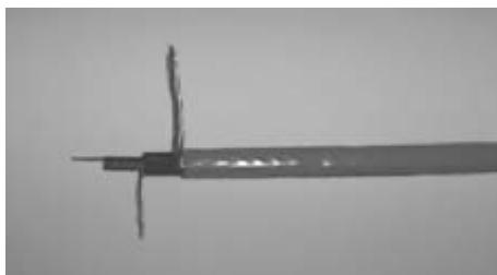
3. Fjern herefter de yderste 20 mm af primærisoleringen. Brug kniv. Klip kærnematerialet op langs den ene ledere, og frigør denne. Endelig fjernes kærnematerialet fra de yderste 10 mm af den anden ledere.
