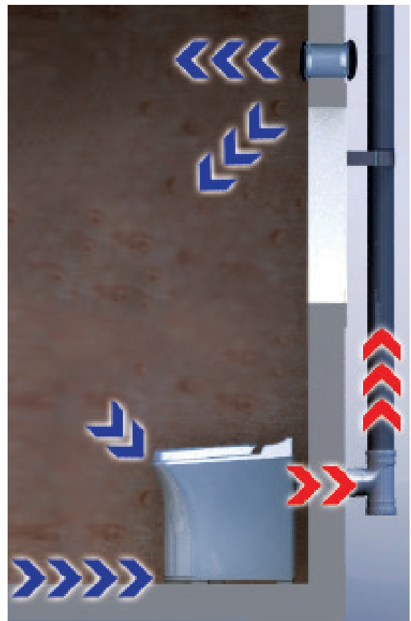
Toalettet drar inn luft fra undersiden og rundt lokket. All luft ut går gjennom rør i vegg.
