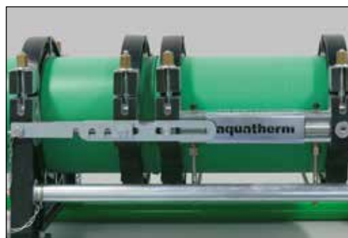
Trekk sammen rørene. La kjøle under trykk
