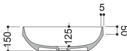
N.B.: Le misure indicate possono subire una variazione dello 0,8 % circa, dovuta ad usura stampi o a piccole variazioni delle caratteristiche tecniche relative alle materie prime che compongono l' impasto.
